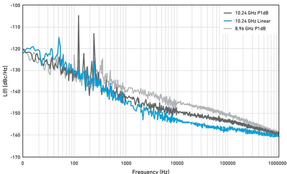
Figure 4. CMD167 LNA phase noise.
