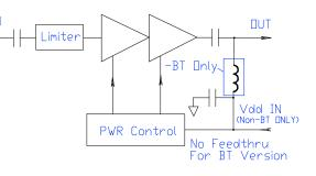
WLLA14-3030C 1.2- 1.6 GHz LOW NOISE WIDE BAND LIMITER AMPLIFIER
